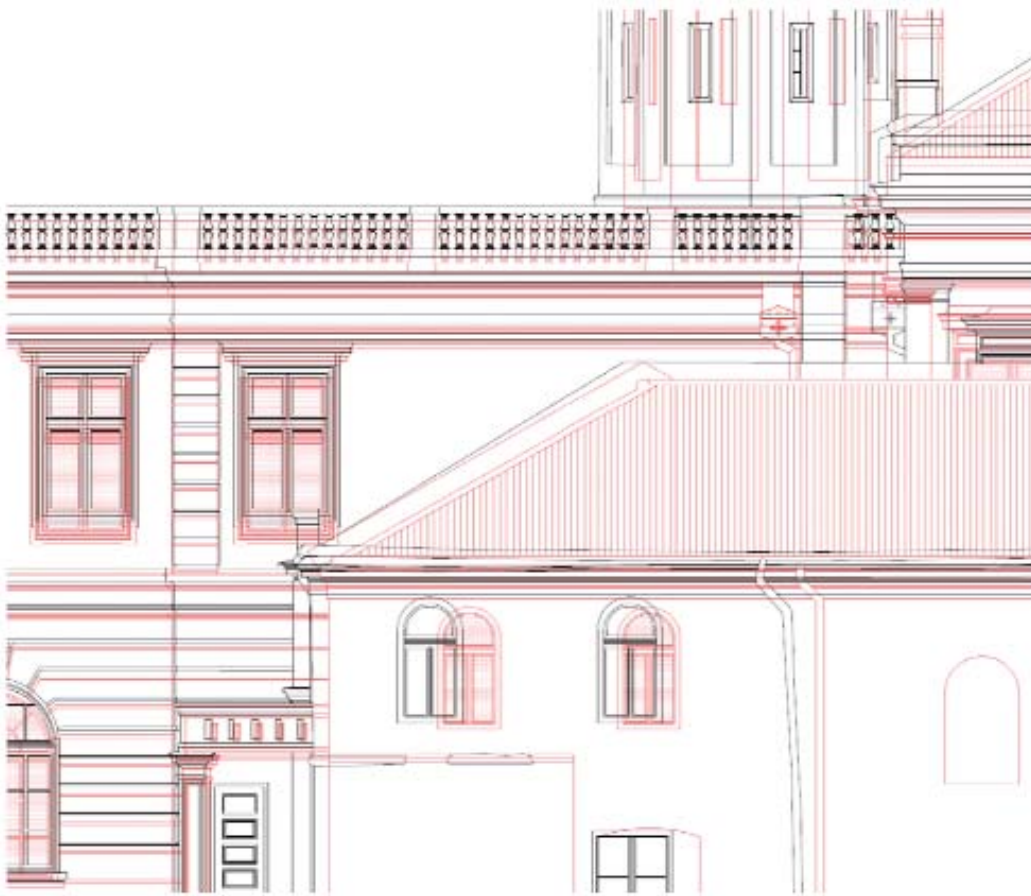
8. ábra. Hagymányos felmérés alapján készített homlokzati rajz (piros szín) és pontfelhő alapján digitalizált homlokzati rajz (fekete szín) eltérése
